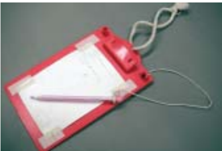
写真9 クリップボードに耐水紙をビニールテープで貼り付けた水中ノート
