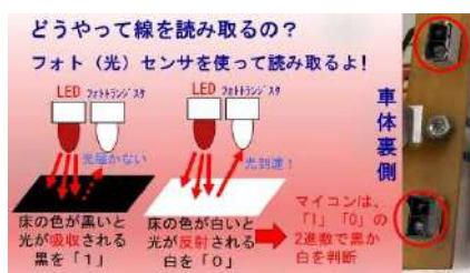
図 52 反射型フォトセンサの仕組み
