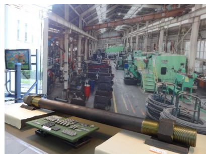
図2 橋梁に使われる長さ3m、太さ180mmの巨大なねじ
