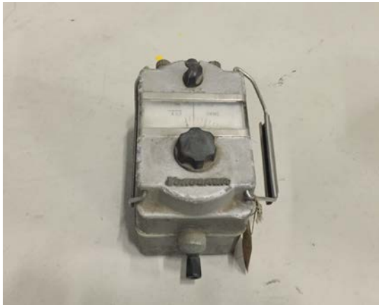
⑦接地抵抗測定器 横浜電機製作所 L-9B
