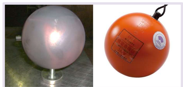
左：重心検査器上で安定したハンマー。規格内に重心があることを確認します。右：オレンジ色に塗装され WA のシールが貼られた完成品。
