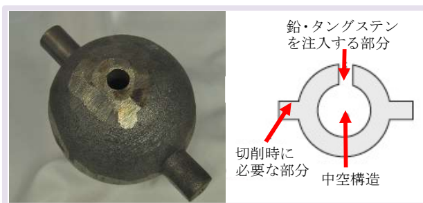
ダクタイル鑄鉄製のハンマー素材。中央の空洞部分に 300 度に熱した鉛とタングステンを注入します。重心位置を調整する手法は企業秘密。
